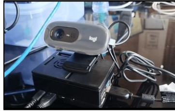
Gambar 1. Prototype Raspberry Pi yang Terhubung ke Web Camera
