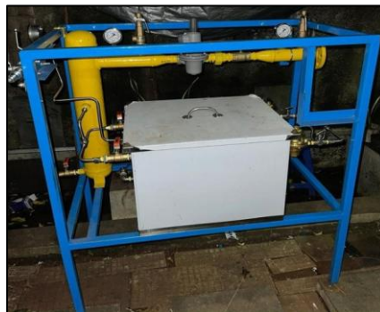
Gambar 6. Unit PRS kapasitas 50 Nm 3 /jam hasil perakitan Sumber: PT. XYZ (2024)
