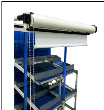
Gambar 7 Hanger proses bonding setelah perbaikan (penambahan cover )
