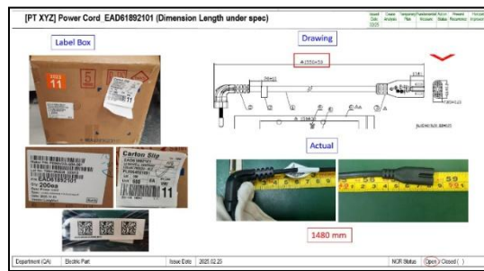
Gambar 6. defect under spec length pada power cord
