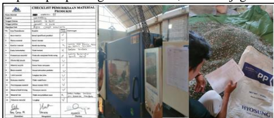
Gambar 7. Penerapan checklist start awal mesin dan pemeriksaan material
