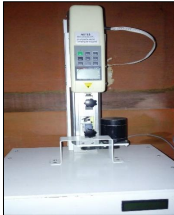
Gambar 3. Alat uji tarik serat tunggal (sumber dokumentasi 2025)
