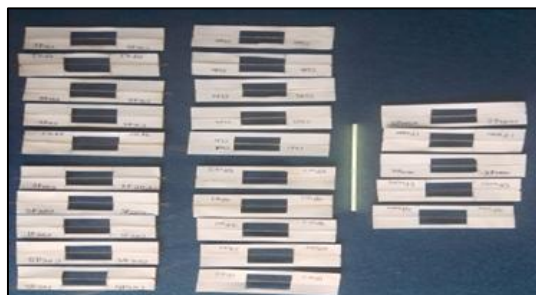
Gambar 2. Spesimen uji tarik serat tunggal (sumber dokumentasi 2025)
