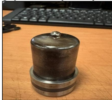
Gambar 2. Lubang Pada Nozzle No.8
