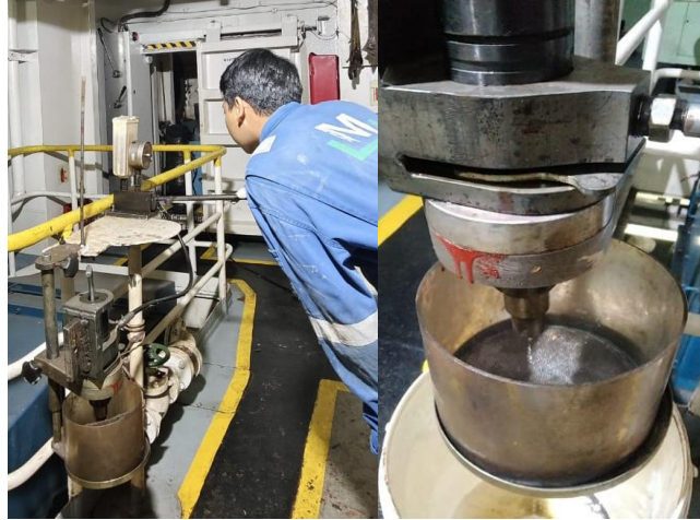
Gambar 3. Pengetesan Nozzle Injector No. 8
