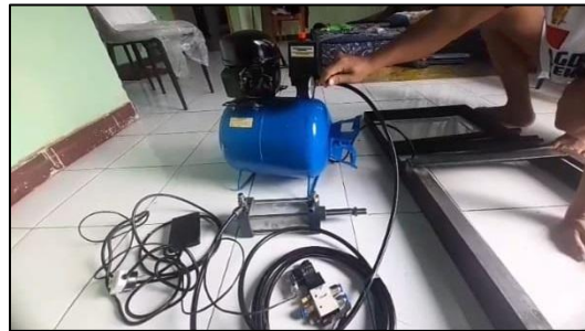
Gambar 3. Hasil rancangan Scissor lift Pneumatik menggunakan kompresor kulkas dan tabung Freon
