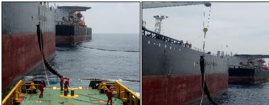
Gambar 3. Pengambilan oleh Crane Tanker
