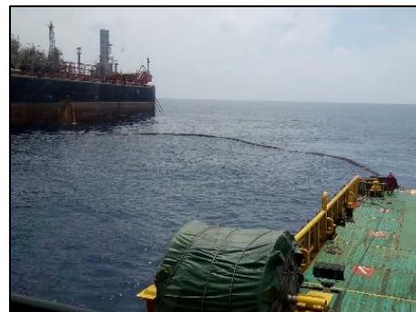
Gambar 2. Pengantaran Floating Hose
