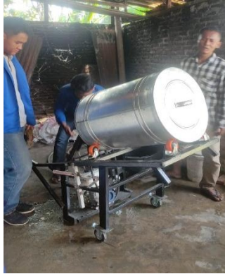
Gambar 6. Produk Jadi Alat Pembersih Kerupuk Kulit
