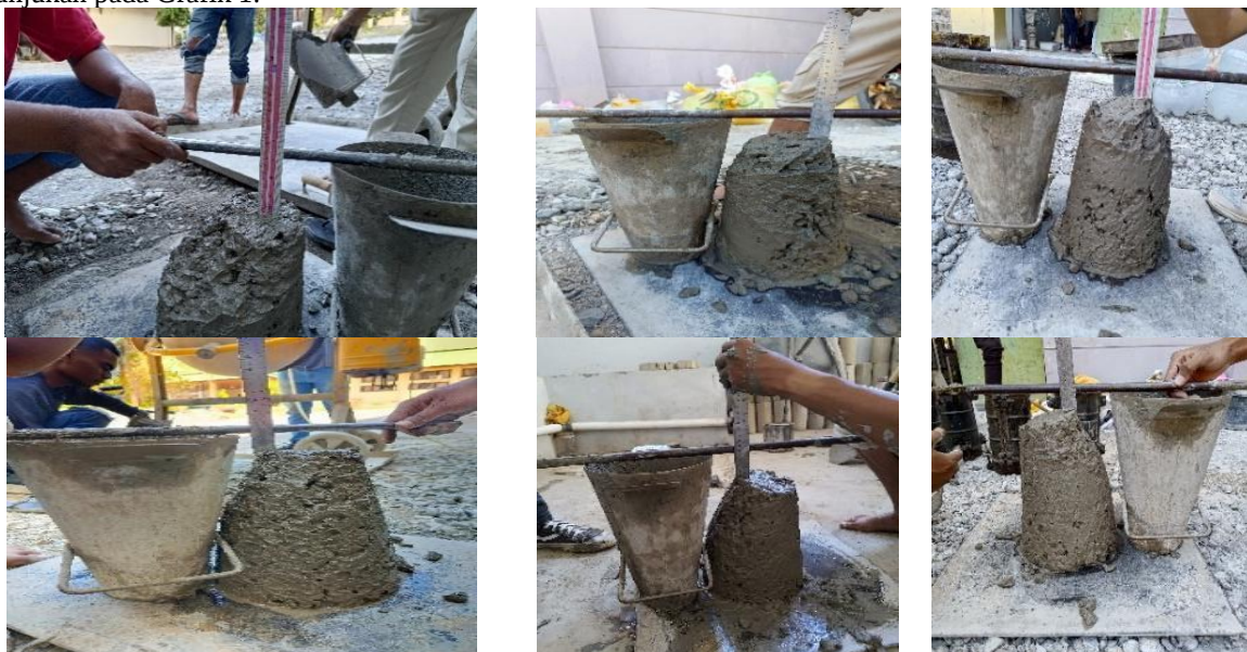
Gambar 2. Pengujian slump beton dengan fly ash Bolok sebagai pengganti semen
