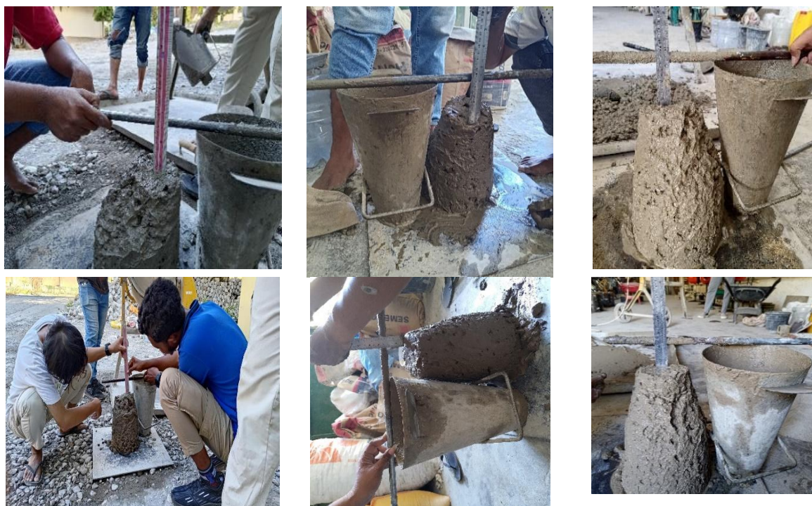
Gambar 3. Pengujian slump beton dengan fly ash Timor-1 sebagai pengganti semen
