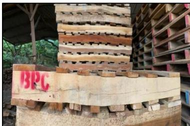
Gambar 2. Cacat kayu retak
