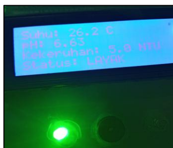
Gambar 19. Pengujian TK kondisi jernih
