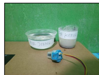
Gambar 13. Uji sensor turbidity dengan kondisi air jernih dan keruh
