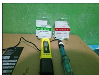
Gambar 12. Uji pembacaan parameter pH digital dan sensor pH menggunakan buffer
