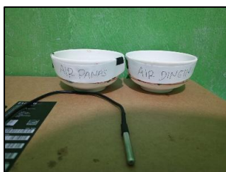
Gambar 11. Uji sensor suhu dengan kondisi air panas dan dingin
